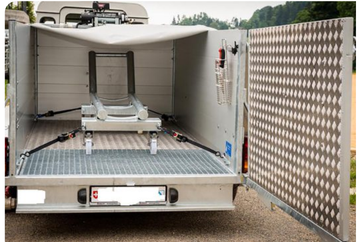
Abb. 3: Innenansicht des T-Trailers I zur Weidetötung von ISS – Innovative Schlachtsysteme mit Schragen. Foto: Trampenau
